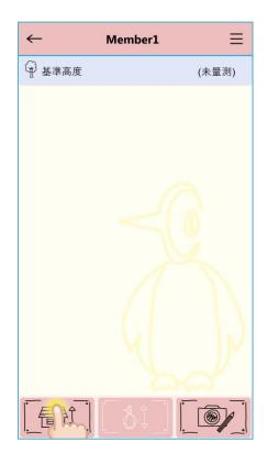
進入到專案畫面後,先點選 左下角基準高度鍵(房子圖 案)以建立一個基準高度。
