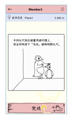
依照圖示操作,將 iPin 光尺 放妥時按下「完成」鍵再將 iPin 光尺移開。
